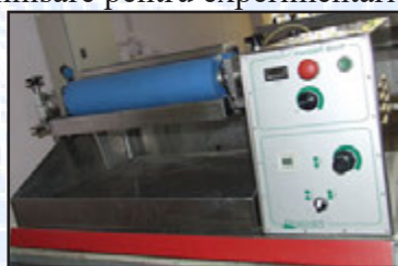
Fig. 31. Fular pentru impregnarea materialelor textile cu substante polimerice si de functionalizare (ROACHES, Anglia)
