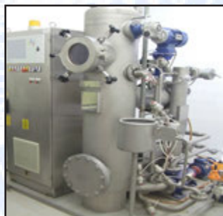
Fig. 36. Aparat de vopsire la T.I. tip jet pentru pregatirea si vopsirea materialelor textile in funie (SCHOLL-THEN, Germania)
