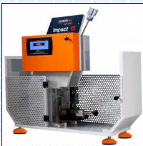
Fig. 125. Aparat pentru determinarea rezistentei la soc Charpy si Izod
