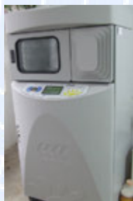
Fig. 87 . Echipament pentru determinarea rezistenței la lumina: Apollo (James Heal- Anglia)
