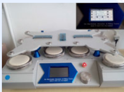
Fig. 169. Determinarea rezistentei la abraziune a tuturor tipurilor de piele prin frecare repetata
