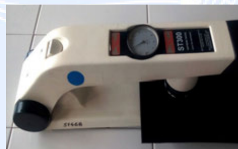
Fig. 170. Determinarea moliciunii pielii
