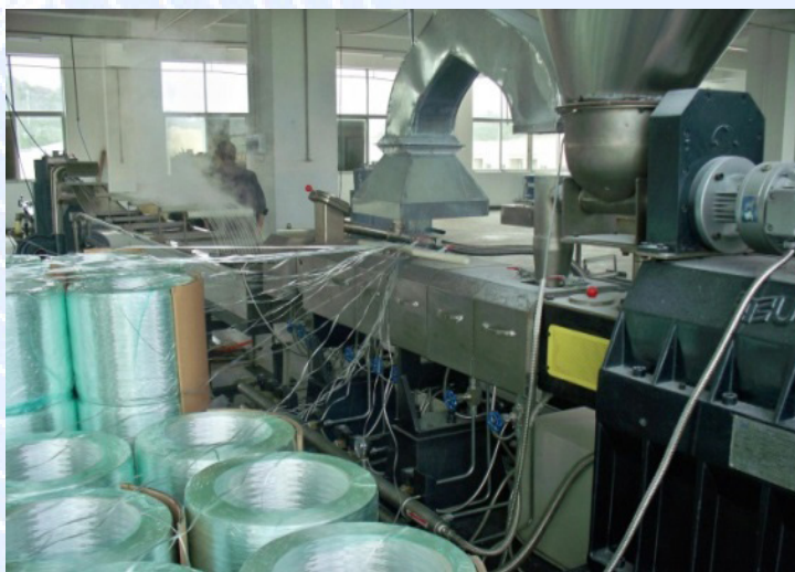
Fig. 128. Instalatie de prelucrare fibre reciclate
