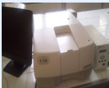
Fig. 160. Spectrometru UV-VIS - Jasco 550
