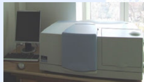
Fig. 73. Spectrofotometru UV- VIS- NIR (Lambda 950, Perkin- Elmer, USA) cu sfera de integrare pentru determinare reflectanta in IR
