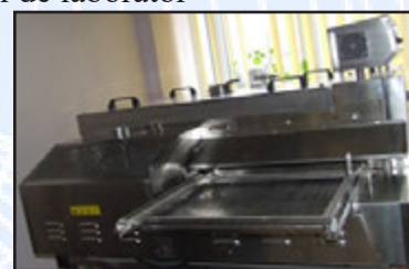
Fig. 32. Aparat de uscare-termofixare-condensare-vaporizare pentru operatii intermediare si finale de finisare superioara, ROACHES, Anglia)
