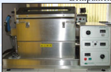
Fig. 30. Jigher automat pentru pregatirea si vopsirea materialelor textile in foaie lata (ROACHES, Anglia)
