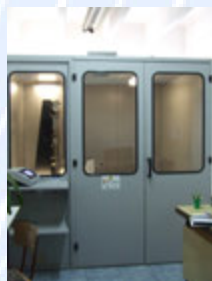
Fig. 88. Aparat pentru determinarea flamabilității, Rhoburn - James Heal, Anglia.
