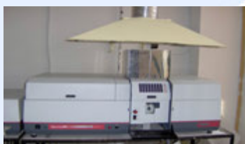
Fig. 75. Spectrometru de Absorbtie Atomica/cuptor de grafit, flacara, VGA - (AAS 800, Varian, Australia)
