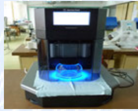
Fig. 78. Echipament pentru determinarea rezistentei la plesnire a materialelor textile plane, James Heal, Anglia
