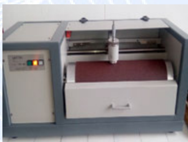
Fig. 168. Determinarea rezistentei la abraziune a talpilor exterioare prin frecare repetata.
