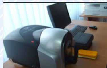
Fig. 35. Spectrofotometru dual reflectanta/transmitanta pentru masuratori de culoare (DataColor, Elvetia)
