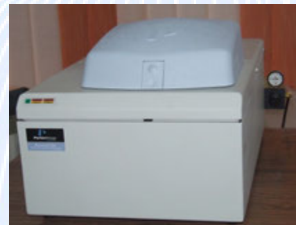
Fig. 86. Calorimetru cu scanare diferentiala, PYRIS Diamond DSC
