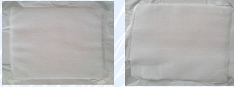
Fig. 100. Nanofibre depuse pe pansamente pliate din bumbac
